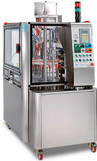
ROTARY 4000 Produccion horaria hasta 4000 Aire aspirado a 6 bar l/min 700 Absorcion Kw 1,2
