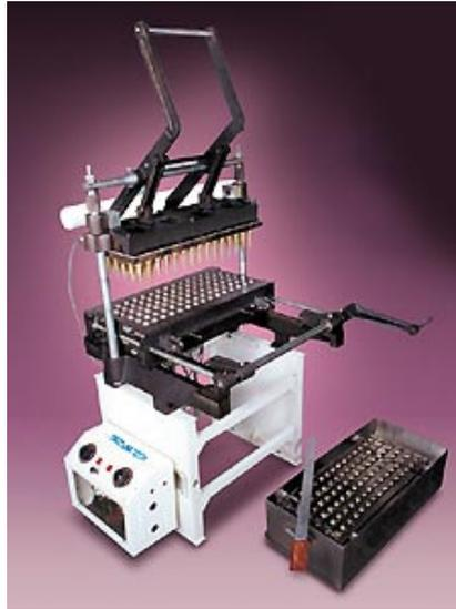
El espesor de las obleas es proporcional a la dimensión de la entre placa. Esta dimensión es ajustable y el paralelismo de las placas se consigue con pernos especiales que sujetan las placas a las estructuras de los portadores.
